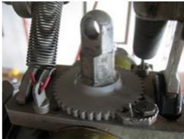
"Jesus-Nut" mit der Verzahnung zur Sicherung
