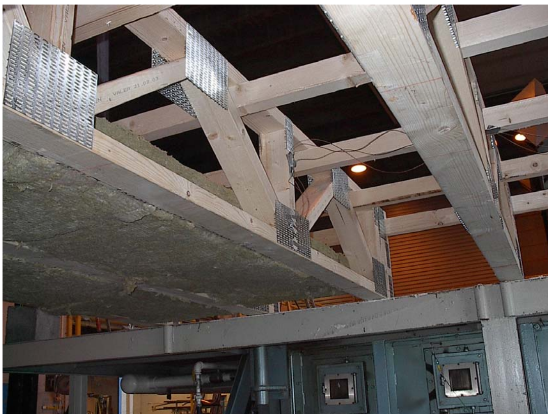
Foto 1 Bjelkelaget under oppbygging, merk termoelementplasseringen på spikerplaten.
