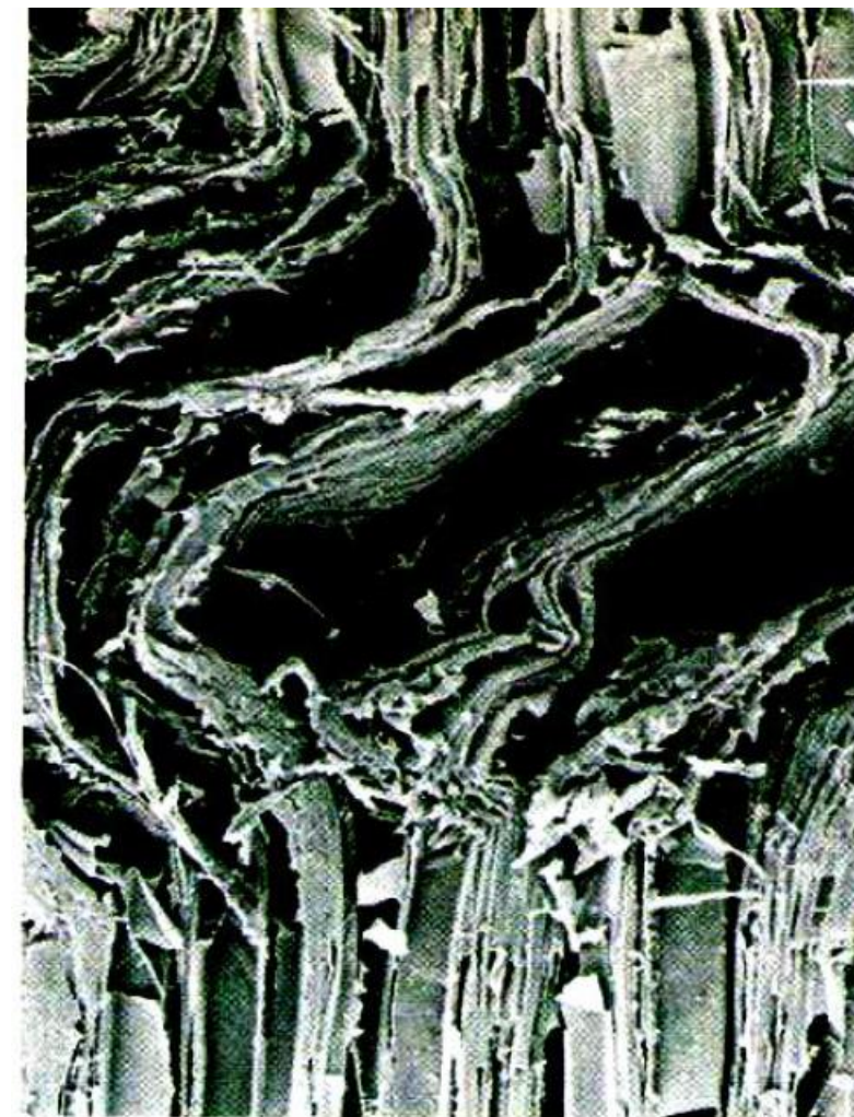
Dette mikroskopbildet viser hva som skjer når en stolpe utsettes for høy trykkbelastning. Vi ser på bildet at fibrene bryter sammen. Foto Bohumil Kucera
