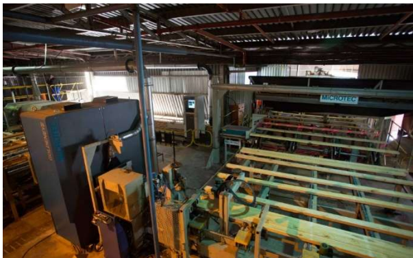
GoldenEye 706, røntgen (Kvist og densitet) og egenfrekvens (lyd) (Microtec)
