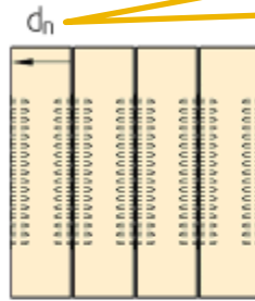
Fig. 2 Definisjon av overdekninger parallelt med og normalt på spikerplaten som angitt i tabell 2. Overdekningen normalt på spikerplaten, d_n , er minste overdekning til spikerplatens spiker eller plate.
