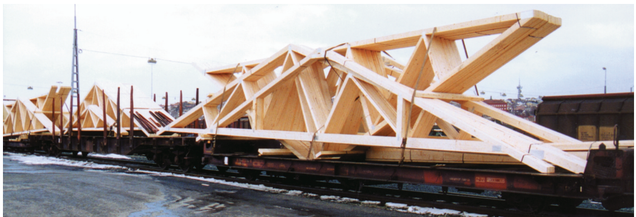
Figur 10.14 Eksempel på jernbanetransport. Her er takstolene plassert med overheng, dvs. at takstolen når inn over nabovogna.
