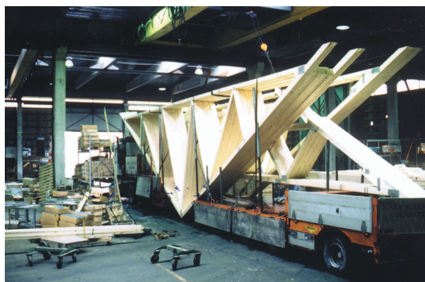
Figur 10.7 Eksempel på semitrailer med uttrekkbar påhengsvogn («svanehalsvogn»).
