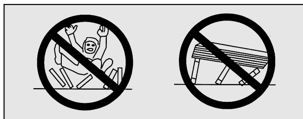
Figur 11.8 Gå aldri på uavstivede konstruksjoner og påfør aldri last før det hele er permanent avstivet.
