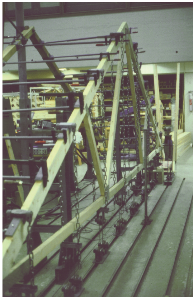
Figur 12.4 Fullskalaprøving av takstol.
