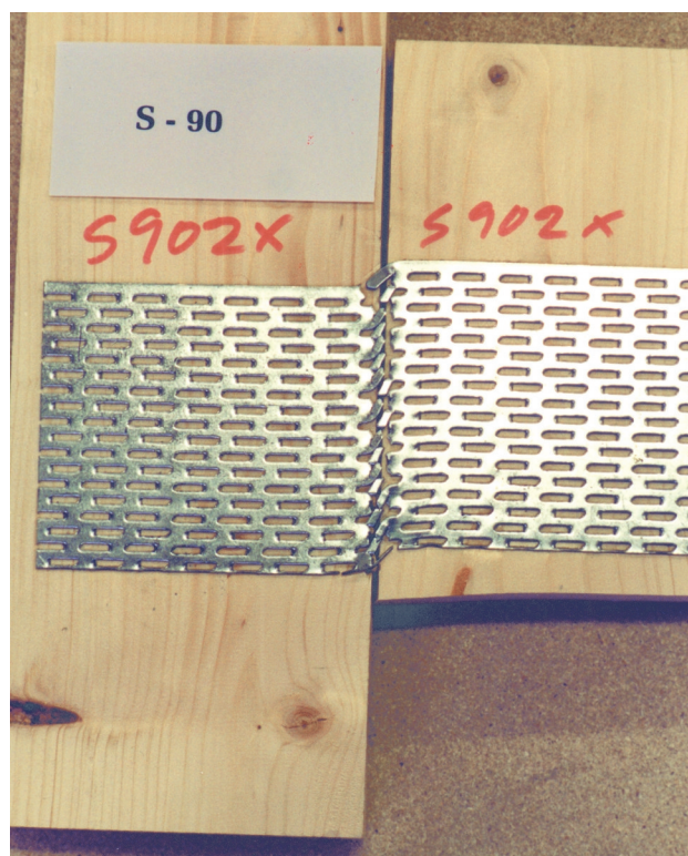
Figur 12.9 Typisk brudd når platen utsettes for skjærkraft.
