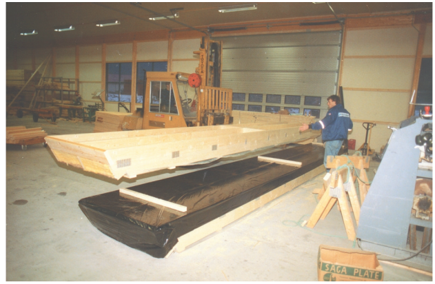
Figur 2.11.3 Sammensatte bjelker brukt i takelementer (kilde: Kaupanger Tre AS).
