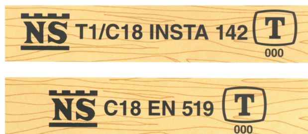
Figur 3.1 Merkene for styrkesortert trelast. Øverst visuell sortering, nederst maskinell sortering.
