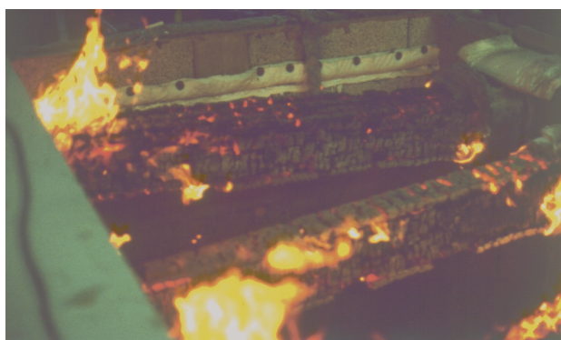
Figur 7.1 Ved å sette flere enkeltbærere inntil hverandre, og samtidig beskytte over- og undersiden med trebaserte plater, oppnås en effektiv isolering av spikerplatene, slik at temperaturene holder seg under 300 °C så lenge de trebaserte platene er intakte.
