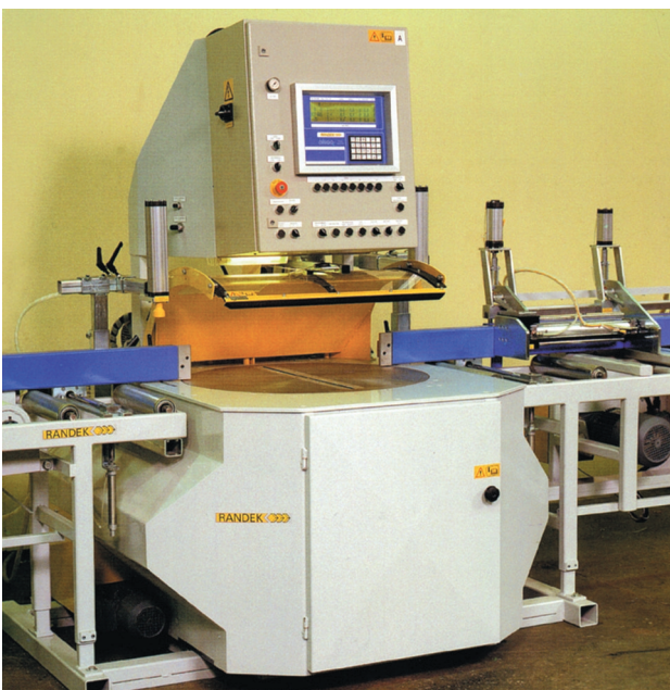
Figur 9.7 Sagbenk med én stor kappsag og automatisk fremmating (kilde: Randek Maskin AB).
