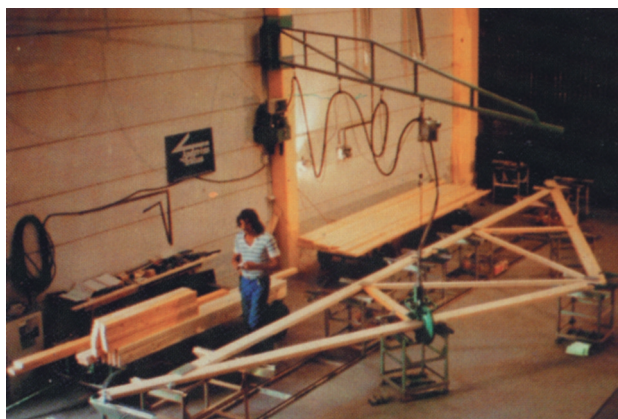
Figur 9.11 Pidestaller med elektromagneter på stålgulv.
