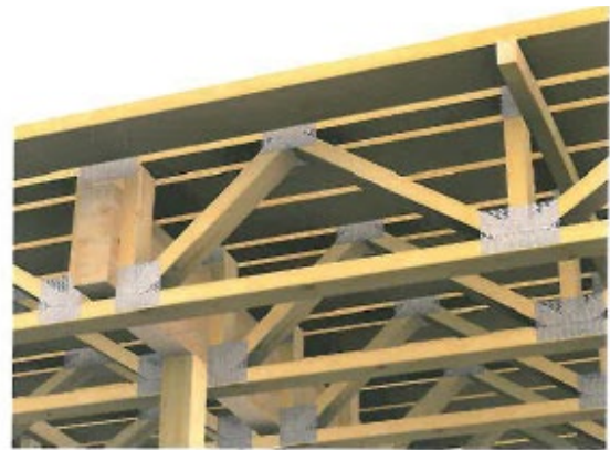
Fig 6 Gitterbjelkelag med tverrgående bærebjelke understøttet av søyle
