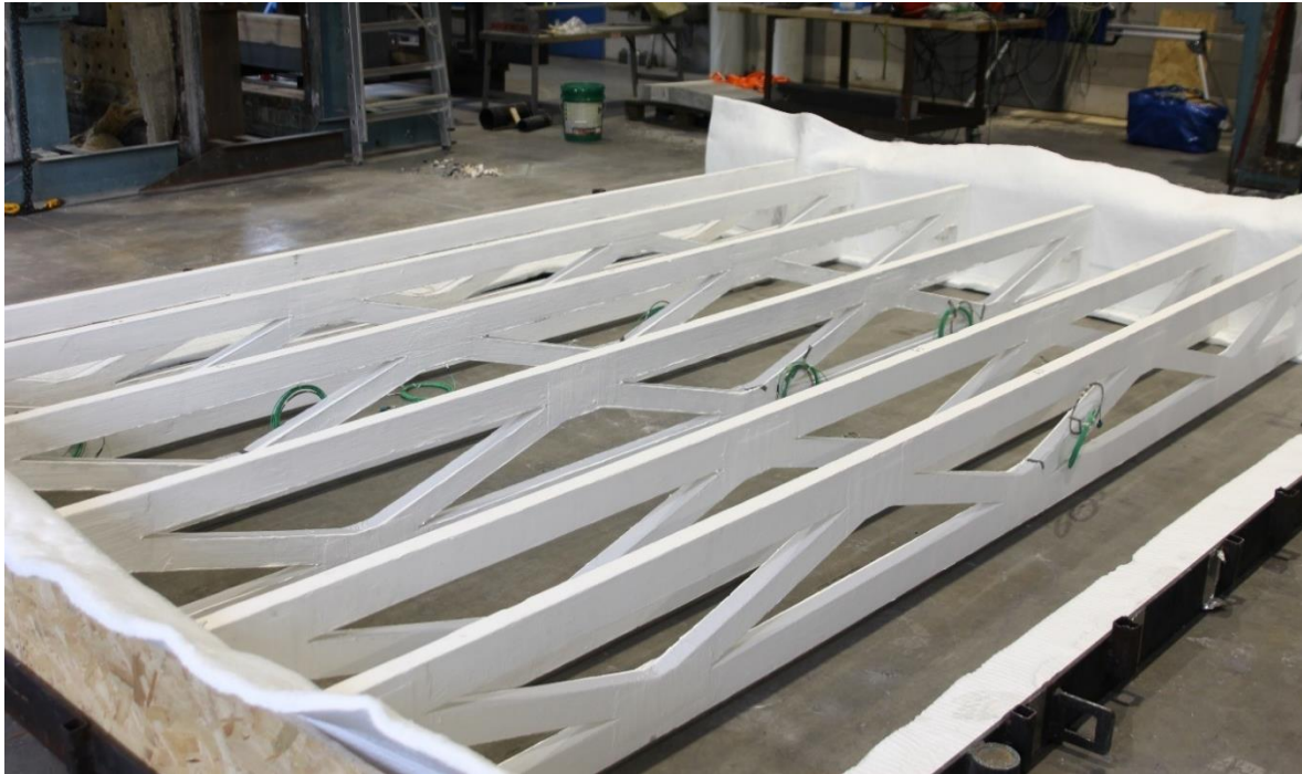
Figur 6 Takstolene ble plassert i en testramme av stål og skrudd til en trefiberplate i begge ender med AES-fiberisolasjon mellom takstolene og testrammen.
