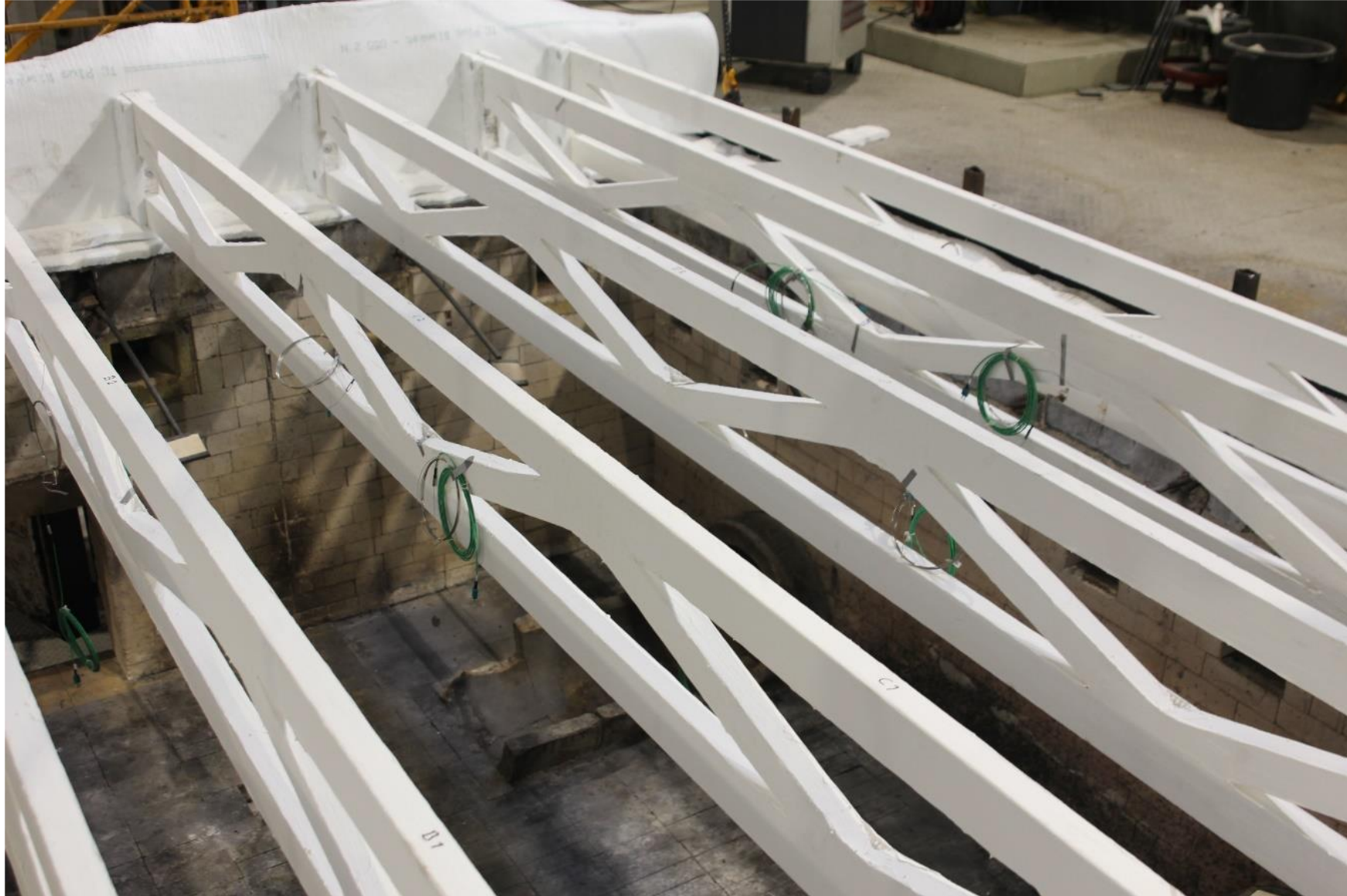
Test 2 – enkle takstoler med 45 mm virke
